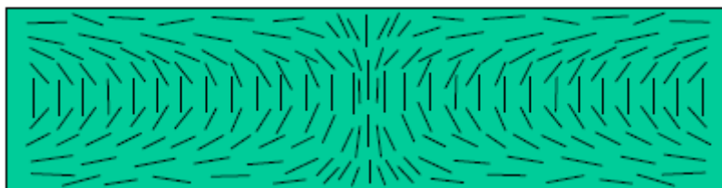
图5. 熔接线中的玻纤方向
